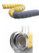
Giętkie przewody 7,6 m BVS 170E - Ø 407 mm - 4031.401 BVS 290E - Ø 610 mm - 4031.038 Pierwsze 2 m (w kolorze czarnym) wykonano z materiału odpornego na temp. do 150°C Opaska zaciskowa w zestawie
